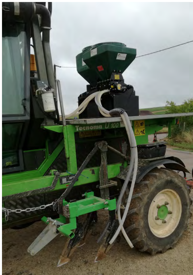
Exemple de semoir Delimbe dont les tuyaux de sorties sont redirigés vers les rangs.
